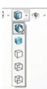
Moguće je podešiti sa koje strane želimo da vidimo objekat koji ćemo napraviti (gornja slika) kao i na koji način će to biti prikazano u prostoru (donja slika). Na ove opcije možemo se vratiti kad izmodeliramo kocku.
