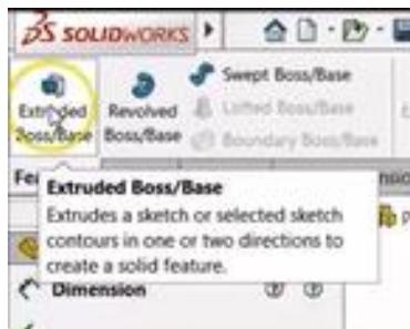
U kartici FEATURE izabratи EXTRUDED BOSS/BASE . Sa leve strane ekrana pojaviće se polje za ukucavanje dimenzije a desno će biti prikazano kako će takva dimenzija da izgleda. Kucamo 25mm i potvrdimo na ENTER na tastaturi.
