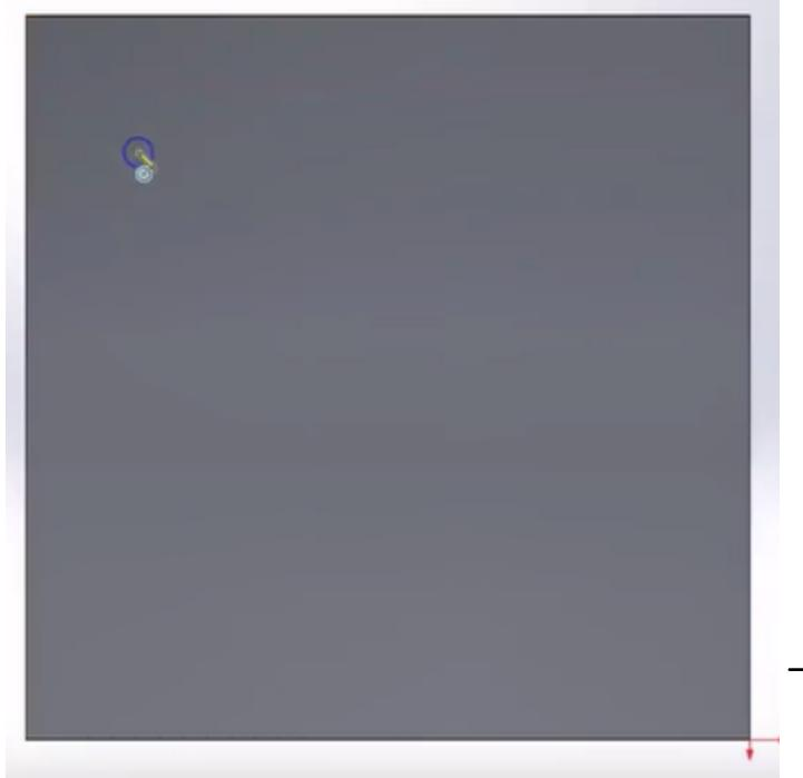
Kružnica se crta tako što se klikom na površinu kocke postavi njen centar, a zatim se pomeranjem miša nasumično razvuče kružnica i potvrđi se još jednim klikom miša. Dimenzije se naknadno postave.
