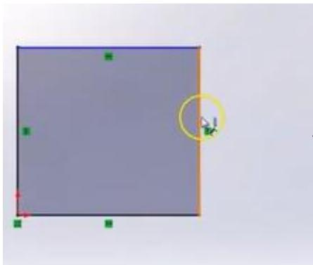
Kliknuti na jednu liniju nacrtanog pravougaonika i prevući miš i fiksirati kotu još jednim klikom. Pojaviće se polje za ukucavawe dimenzije. Treba ukucati 25mm jer će naša kocka za jamb imati tu dimenziju ivice.
