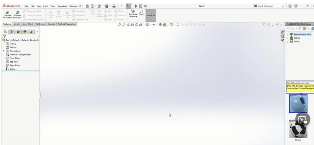
Zatim kliknuti na OK. Nakon toga otvara se okruženje za modeliranje dela.
