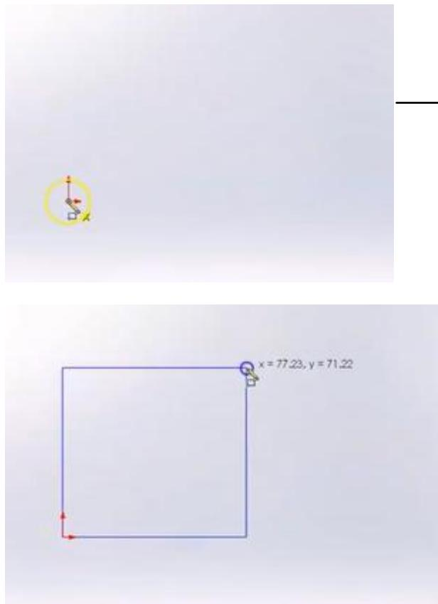
Zatim kliknuti na koordinatni početak, prevlačenjem miša nasumično razvući pravougaonik i kliknuti da se dimenzije fiksiraju, njih ćemo naknadno da kotiramo .
