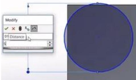
Zatim ukoliko je potrebno, ponovo kliknuti na SMART DIMENSION, i ovaj put prvo selektovati kružnicu (kao referentnu tačku automatski će program uzeti centar kruga) a zatim selektovati ivicu naše kocke, tu dimenziju staviti da bude 12,5mm. Na isti način iskoristiti i rastojanje kruga od druge ivice kocke.
