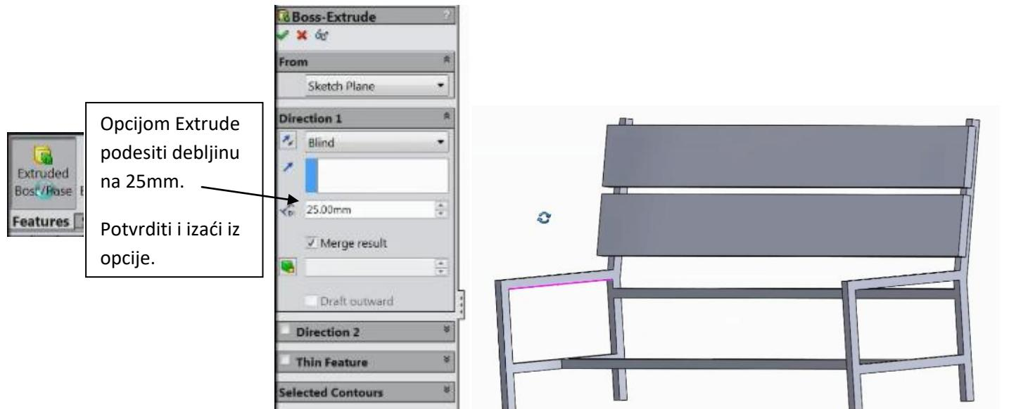
Za crtanje skice za sedište, izabrati površinu na koje se sedište kači. Nacrtati dva pravougaonika kao na slici dole i postaviti dimenzije.
